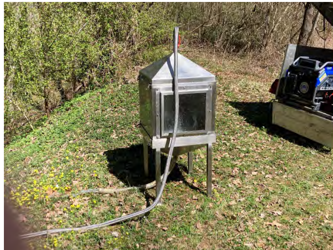
Abbildung 15: Filtrationsapparatur mit Zulaufschlauch und Pumpe (Hintergrund) (© Amt der Kärntner Landesregierung)
